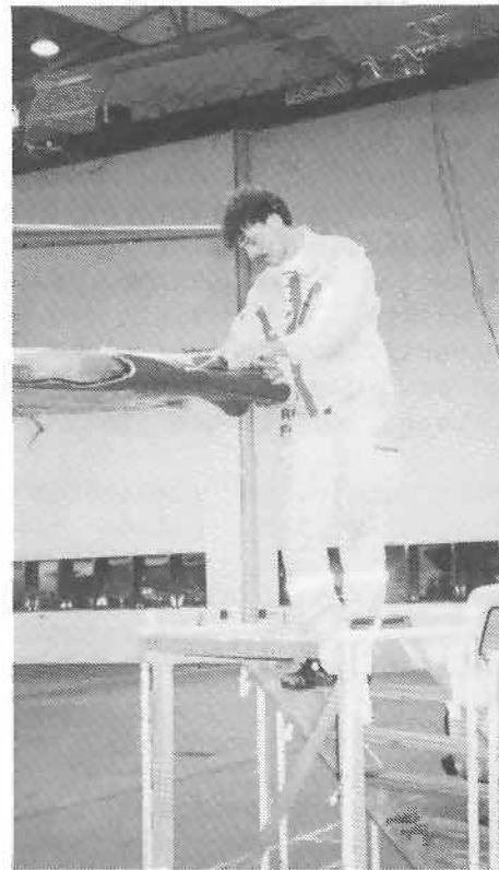
Sjekk av lynavledere etter lynnedslag.
