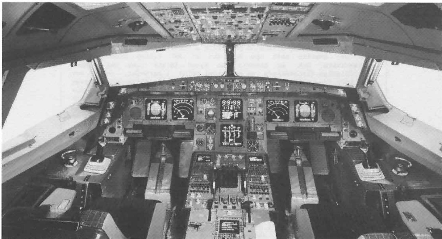
Cockpit på Airbus A340. Joy-stick og fly by wire.
