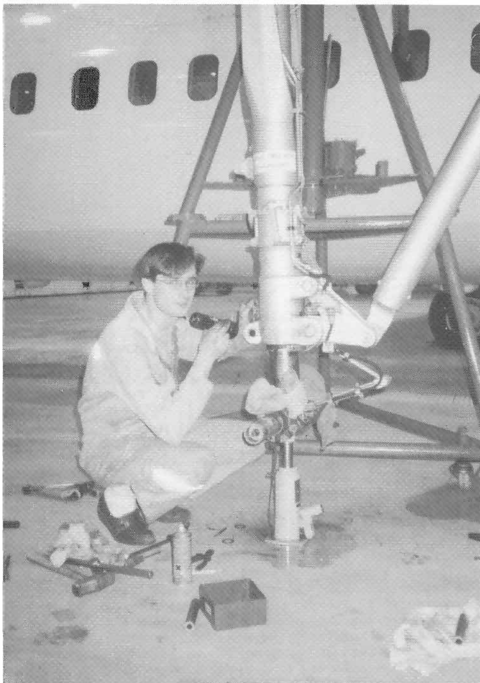
Pakningsskift på understellet til F50 i Bodø. Foto: Torstein Vikøren
