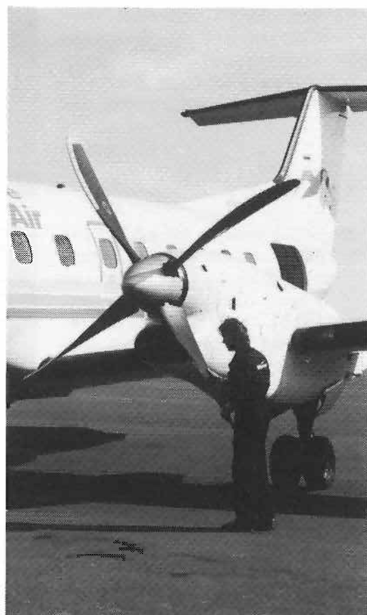
Propellene sjekkes for delaminering
