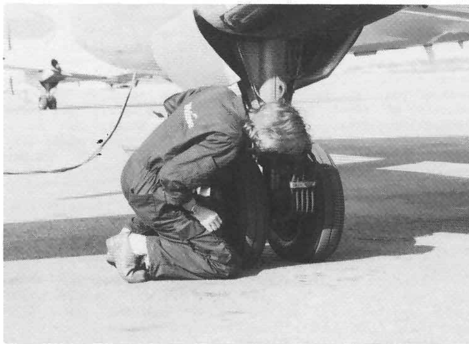
Kim Söderberg sjekker bremsene for slitasje
