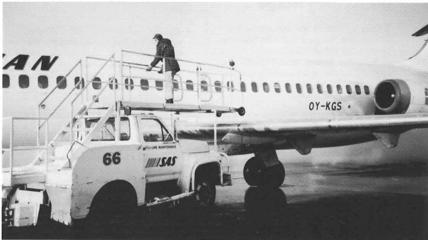
Mekaniker kontrollerer at all is er fjernet etter avising. Foto: Knut Grønscar
