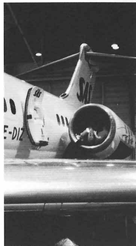
Kontroll av fan-blader.
