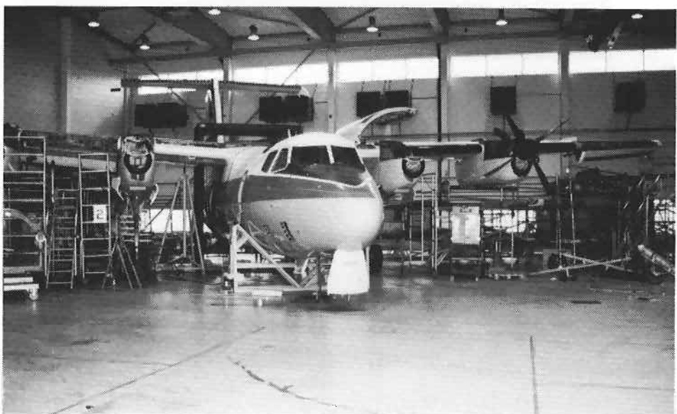
Platearbeidene var så omfattende at flyet måtte i jigg. Fotos: J.B. Valdal
