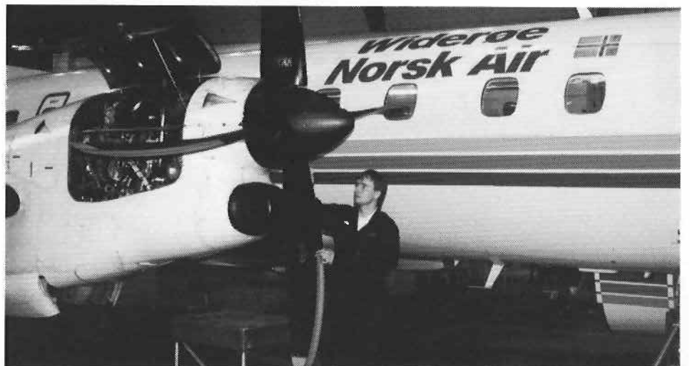
Flytekniker Geir Hansen utfører inspeksjon av propeller. Foto: Paul Lingjærde
