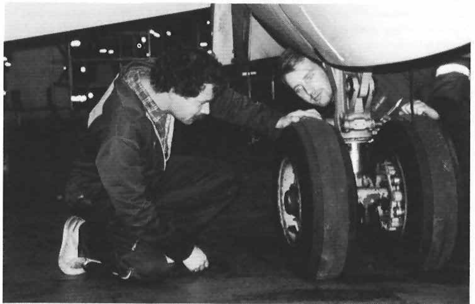
Flytekniker Egil Bjerke og fagarbeider Lasse Andersen sjekker hjul i forbindelse med DI. Foto: Paul Lingjærde
