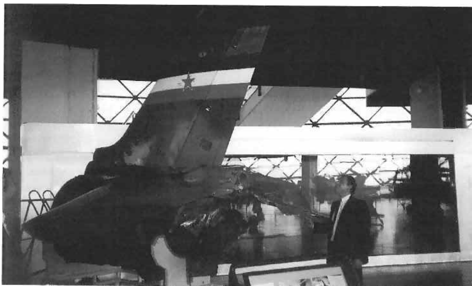
Halepartiet på en jugoslavisk fighter som fikk en fulltreffer i halen. Flyet greide å lande på tross av skadene.
