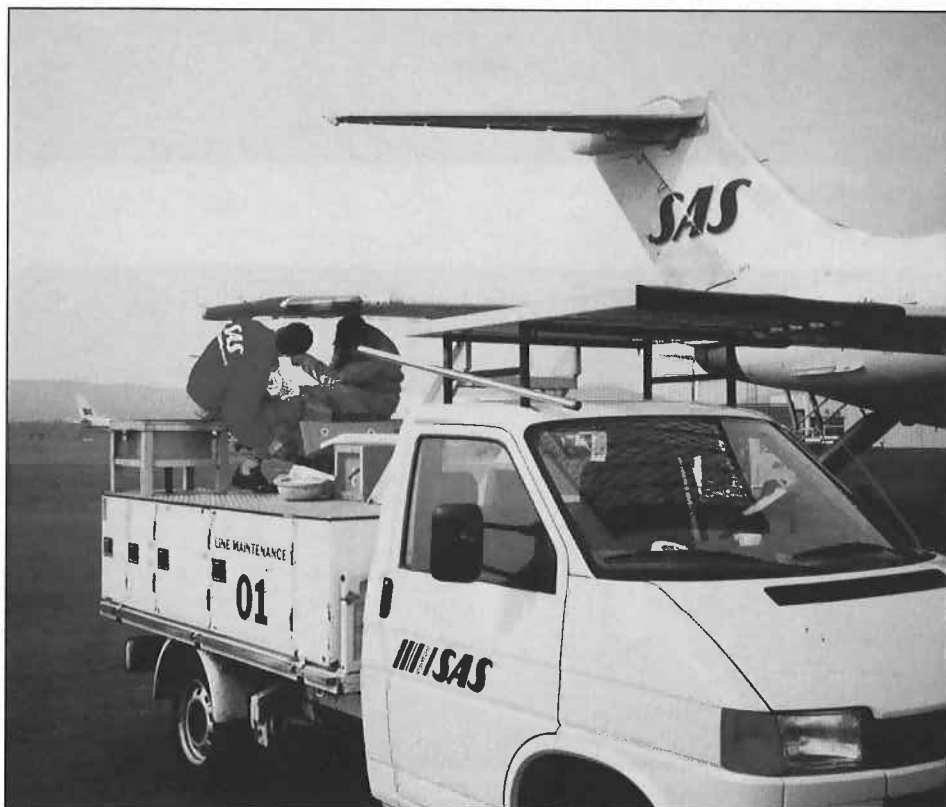
Bytte av wing landing light.
