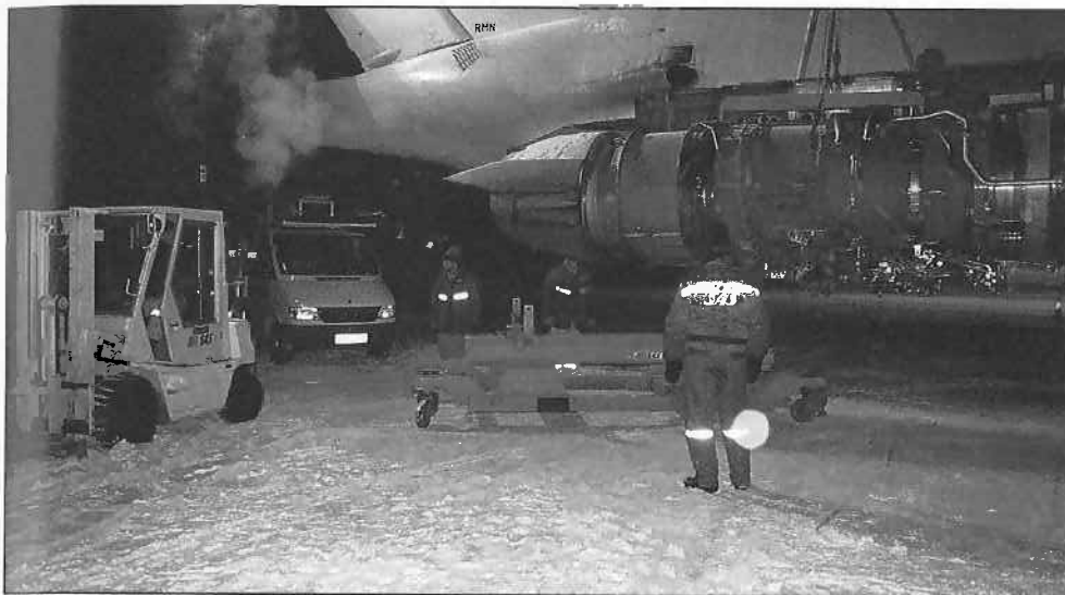
Den gående motoren fires ned i transportvoggen.
