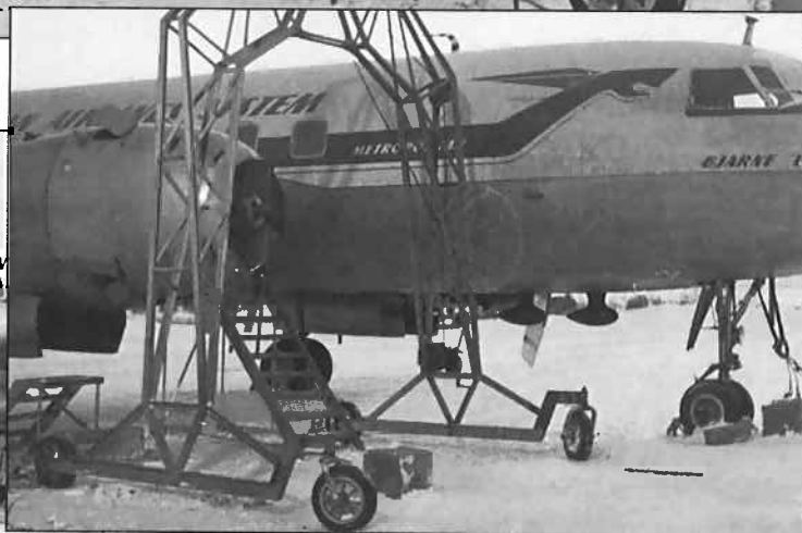
Spesial jigg for peopell- og motorskift.
