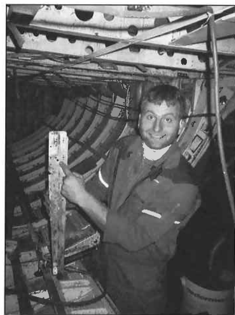
Bjørn Bråtveit med eksempel på korrosjon i cargo, Braathens tekn. div. Sola (KLM D-check).
