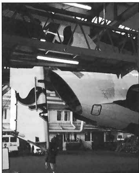
Sprekker funnet i sideroret. Roret byttes.
