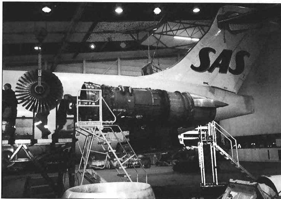
Bytte av skadet kompressor.
