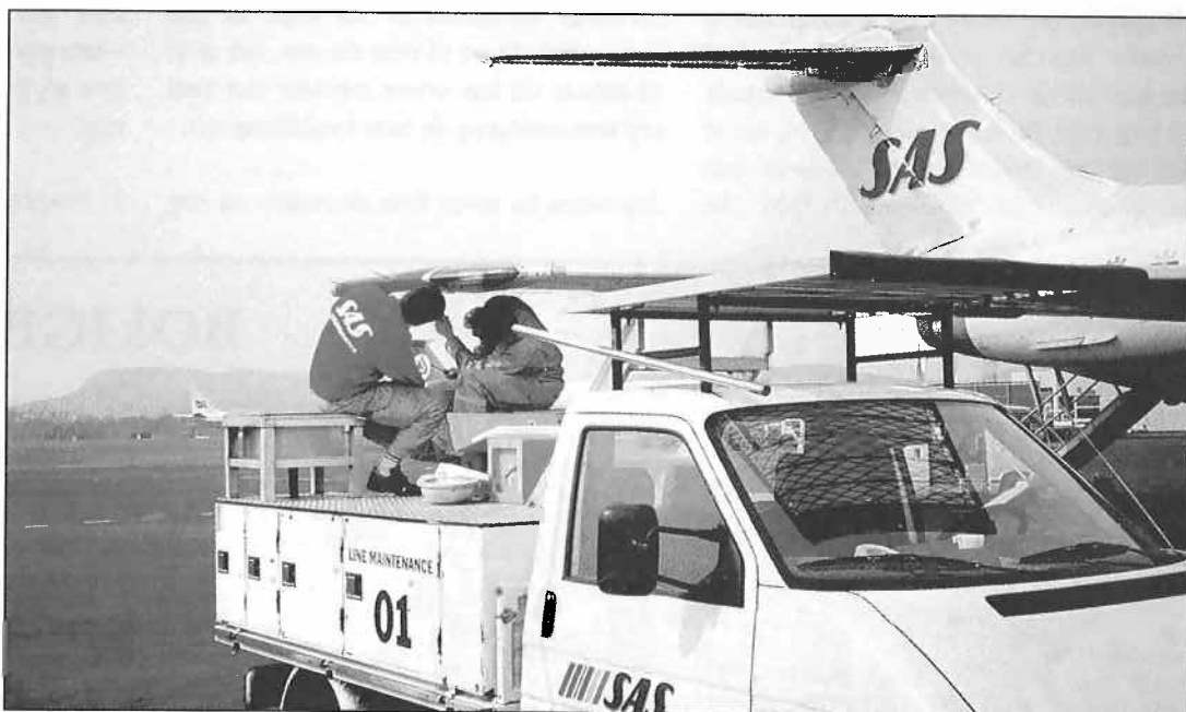
Bytte av landingslys.
