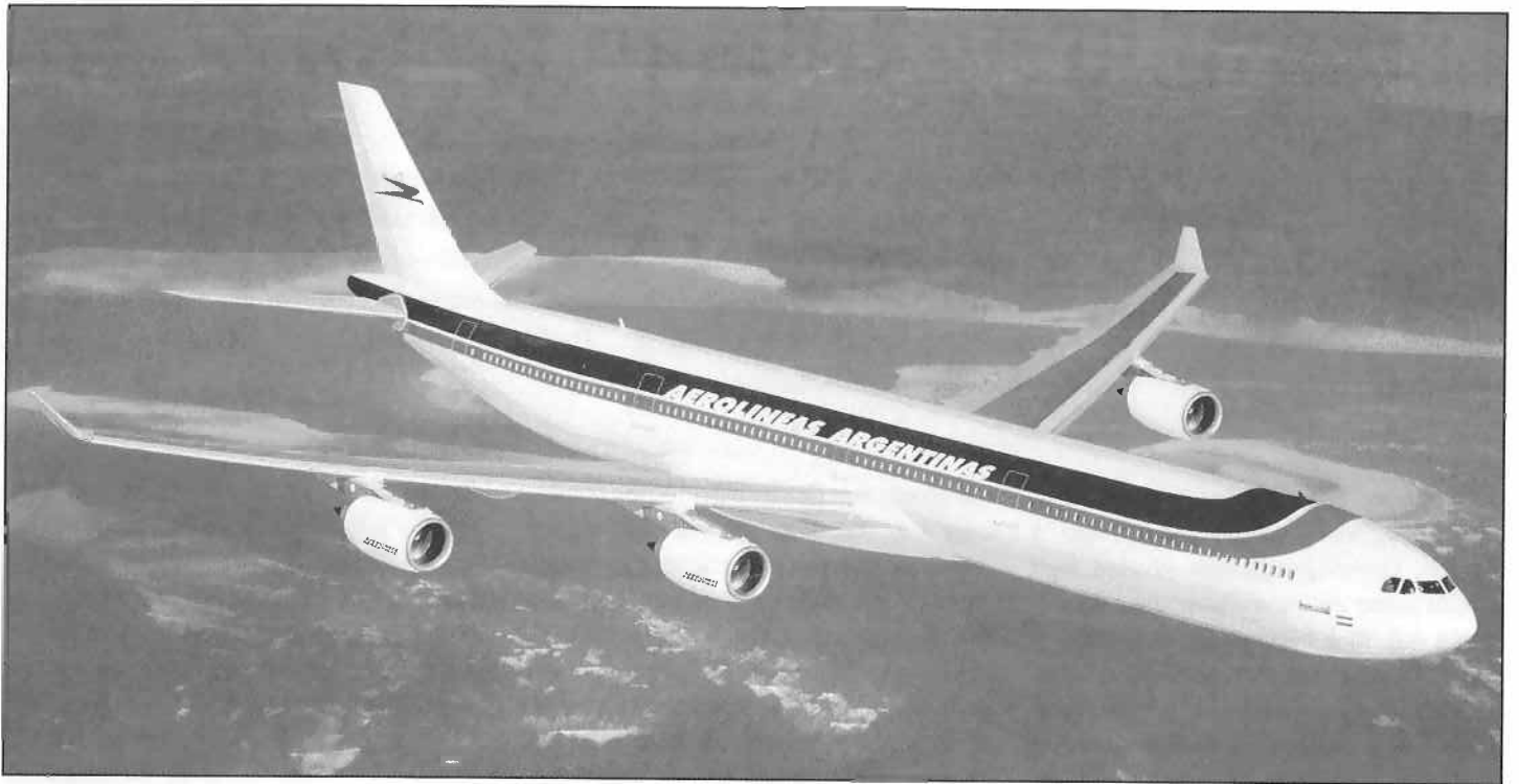
Airbus A340-600 vil kunne ta opptil 378 passasjerer over en strekning på 13.500 km.
